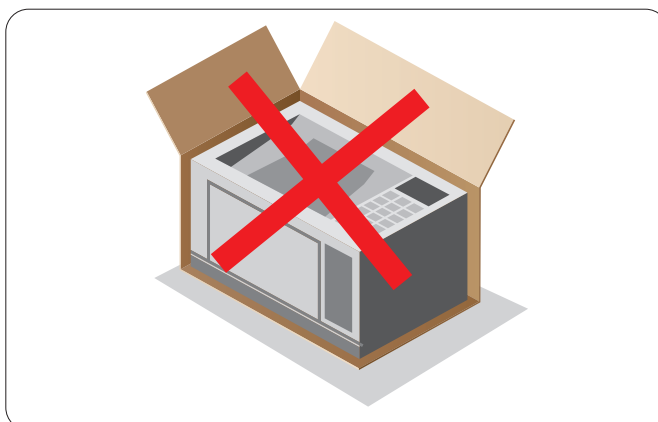
Produkt bez vnitřní výplně Riziko poškození je vysoké!
